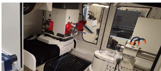
Abb. 1: Messungen bei der Firma Fritz Studer AG an einer S141 CNC-Universal-Innenrundsleifmaschine
