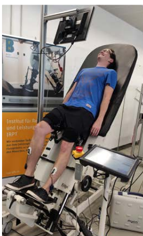
Links: Erigo Roboter mit einem Probanden Rechts: Schematische Darstellung des Versuchsaufbaus
