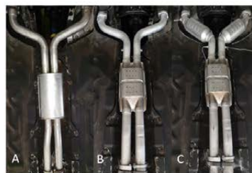
Evolution de la ligne d'échappement A. Silencieux initial B. Catalyseur principal C. 2 pré-catalyseurs et catalyseur principal
