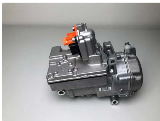
Originaler Renault Zoe HVAC-Kompressor, dessen Kommunikation mit dem Fahrzeug untersucht wurde
