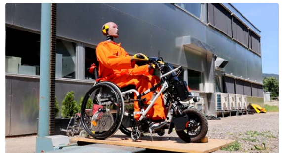
Versuch: Bestimmung lateraler Kippwinkel Lipo Lomo Micro
