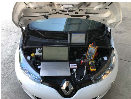
Messaufbau für das LIN-Bus Reverse Engineering
