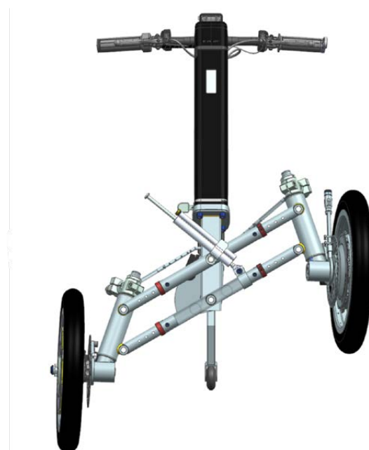
Pendelachse mit maximalem Höhenausgleich
