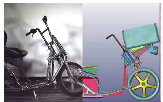
Abbildung 2 Der neue Träger hat den Aufprall gedämpft, jedoch den Rahmen noch immer leicht verbogen.
