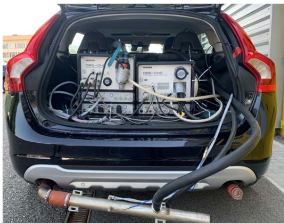
Messaufbau für die Realfahrt-Messungen auf der Strasse
