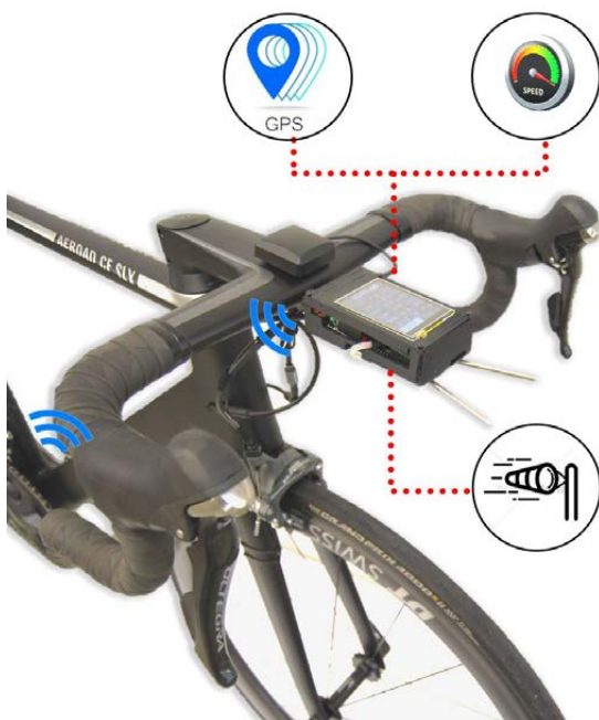
Aerovélo monté sur le vélo prêt à effectuer une mesure sur la route
