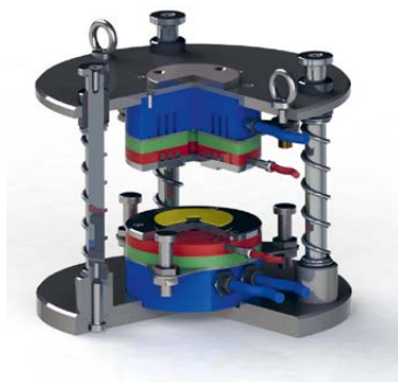
Versuchsaufbau zur Erfassung der Eigenschaften von Dichtungsmaterialien
