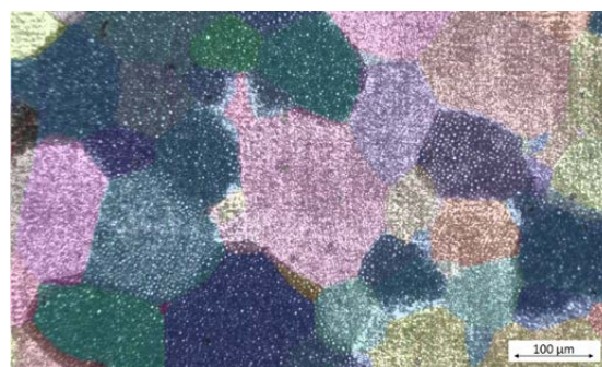
Abb. 2: Ergebnis einer EBSD-Messung auf Oberfläche nach Laserbearbeitung (Elektroblech ohne Kornorientierung)
