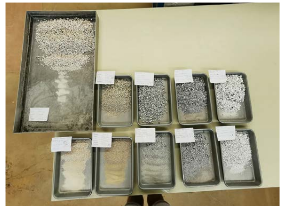
Bestimmung Kornverteilung heller Gesteinsproben zur Mischgutherstellung
