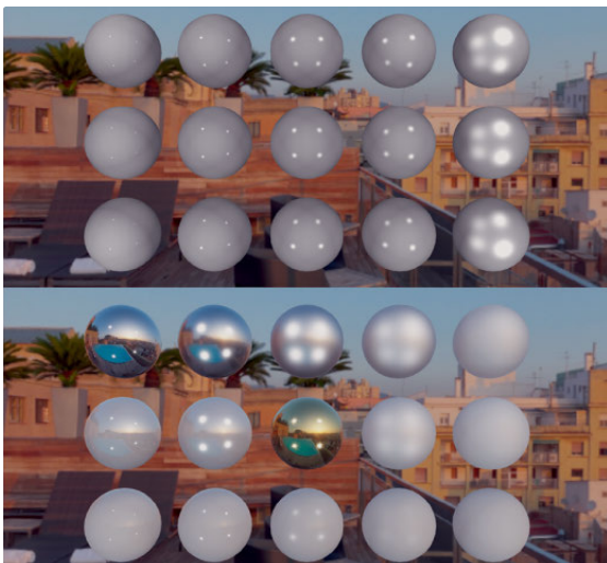
Vergleich zweier Beleuchtungsmodelle. Oben: Blinn-Phong-Modell; Unten: physikalisch basiertes Modell.
