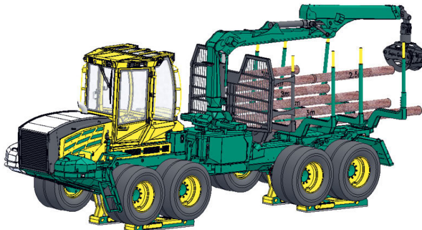
Die Kombination von vier Hubsystem ermöglicht das Anheben der unterschiedlichen Maschinen mit Bogiefahrwerk.
