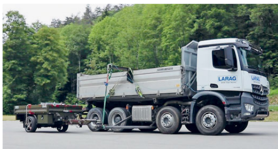
Versuchsaufbau mit seitlich gekoppeltem 2.8t Anhänger
