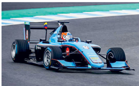
Les GP3 de 2018 ont des moteurs 6 cylindres de 3.4 litres développant 400 CV et pèsent 625 kg avec le pilote.
