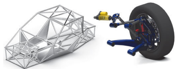
Chassis und Fahrwerk vorne links
