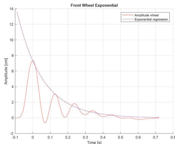
Représentation du mouvement de la roue et de sa fonction d'amortissement
