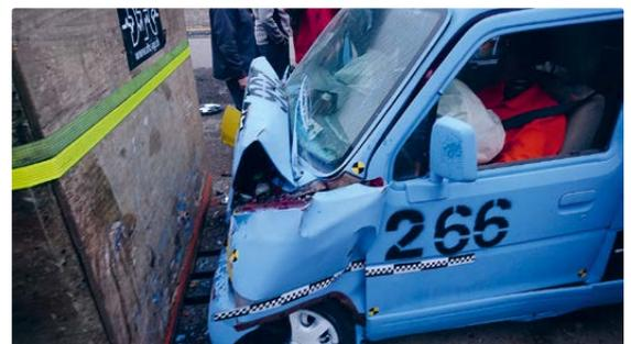
Totalschaden nach Aufprall mit 57 km/h
