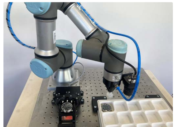
Abb. 2: Aufbau mit Teststation, Roboter, Greifer und Kamera
