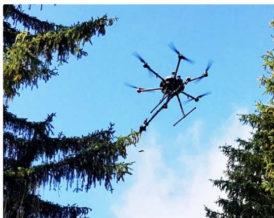
Drone DJI M600 Pro avec système de coupe de pives en vol lors d'un test de coupe en forêt.
