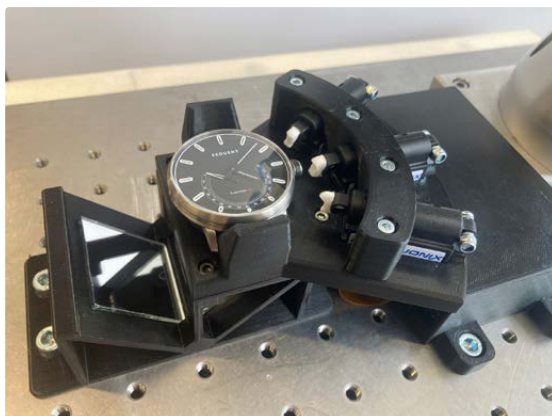
Abb. 1: Nahaufnahme der Teststation mit platzierter Uhr
