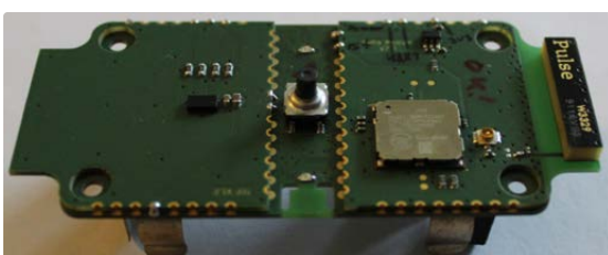
Time-of-Flight Modul (l) und LORA-Modul (r) auf dem Motherboard.
