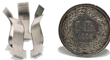
Angefertigte Feder aus Federstahl (Dicke: 0.2mm)
