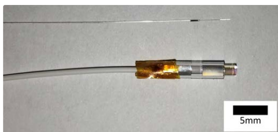
Spezialangefertigte OCT-Sonde (oben) und OCT-Sonde mit dem modularen Glasfaser-Linsen-System (unten).
