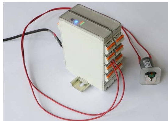
Module montiert auf Hutschiene mit Busverbinder
