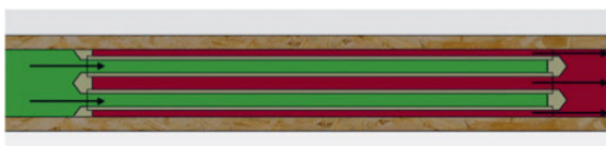
Querstromfilterapparat mit Filterplatten - Zulaufkanäle (grün) und Ablaufkanäle (rot)
