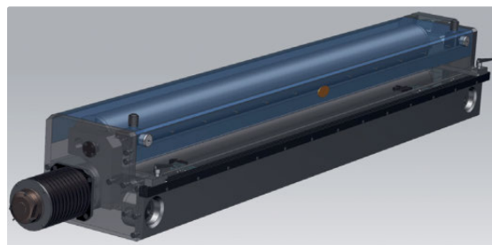
Abbildung 2: 3D-Modell des Walzenvorschubes
