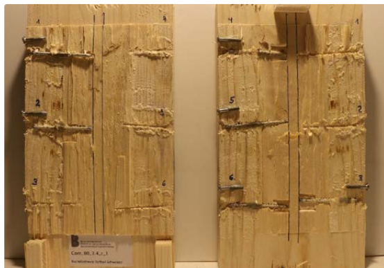
Abbildung 1: Nagelbruch bei gerillten Nägeln.
