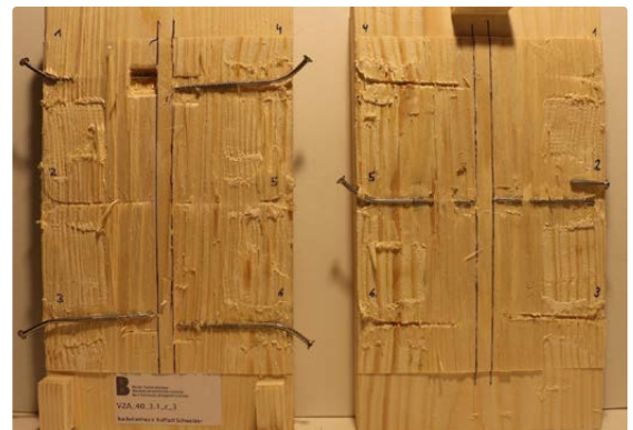
Abbildung 2: Teilgerillte Nägel mit gutmütigem Tragverhalten.
