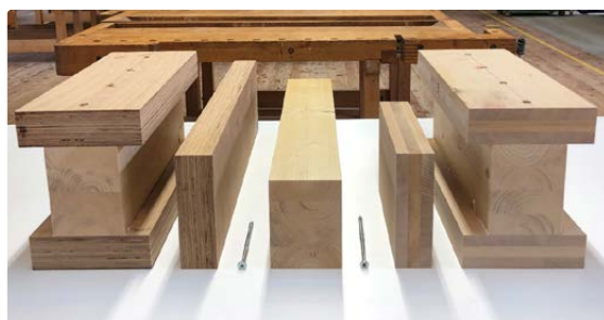
Prüfkörper: schraubpressverklebte Rippenplatten mit hybridem Aufbau
