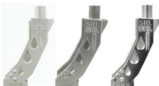
Links: Unbehandelte Probe, Mitte: Probe nach Gleitschleifen, Rechts: Probe nach Gleitschleifen und Elektropolieren
