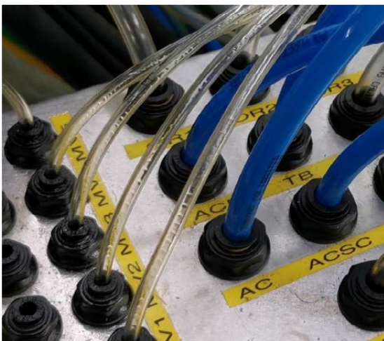
Schmierleitung eines aktuellen Systems auf einem Prüfstand, Schlieren in den Leitungen deutlich sichtbar.
