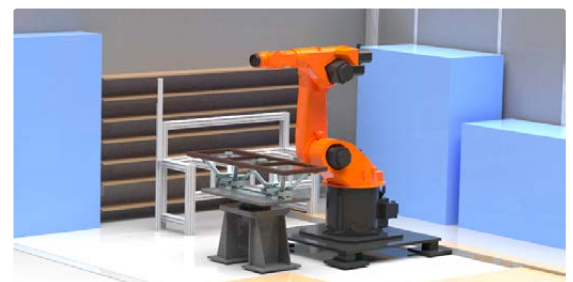
Spannvorrichtung auf dem Drehtisch vor dem Roboter
