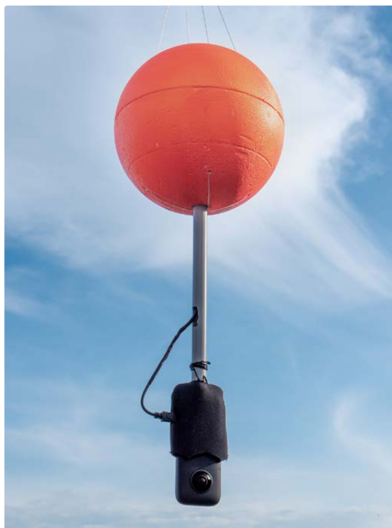
Die Sondenkapsel mit angehängter 360°-Kamera
