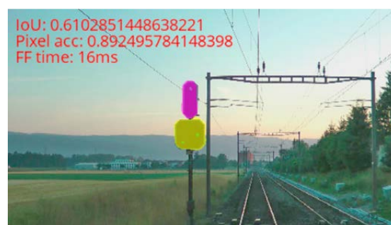
Formgenaue Detektion und Klassifikation von Zugsignalen mit Semantic Segmentation
