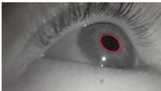
Gefundene Pupille in einem Auge, das mit einer IR-LED beleuchtet wurde.
