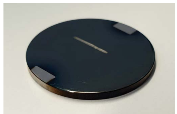
Couche DLC déposée sur un échantillon en acier inoxydable, après un test tribologique. Les marches nous indiquent l'épaisseur.
