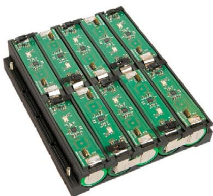
Lithium Akku mit 10 Lithium Zellen und 10 Slave Modulen (links) Master Print (rechts)
