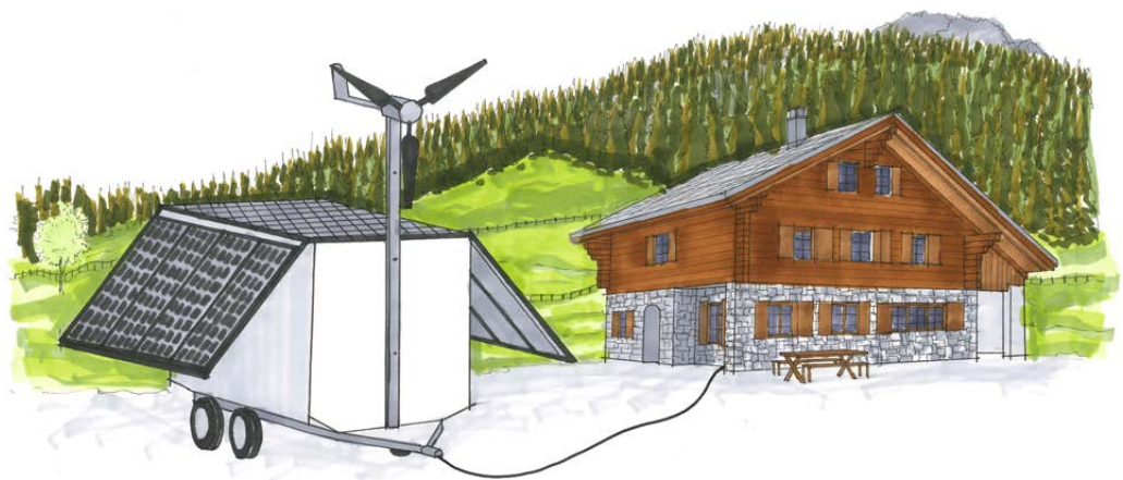
Abb 1: Powertrailer auf der Alp im Inselbetrieb
