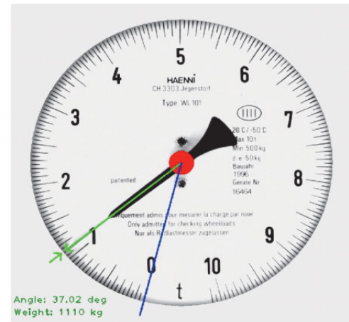
Ermittlung des Zeigerstandes durch optische Bilderfassung
