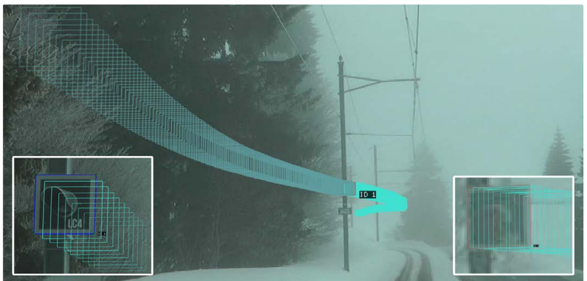
Getracktes blinkendes Bahnsignal bei Nebel. In der Mitte ist das Resultat von 380 Frames sichtbar dargestellt. Links ist das Initialframe, rechts Zoomausschnitt Mitte (nach ca. 130 Frames).
