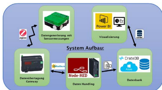
Abb.1: System Aufbau mit den 5 Systemblöcken und den jeweiligen Kommunikationsprotokollen
