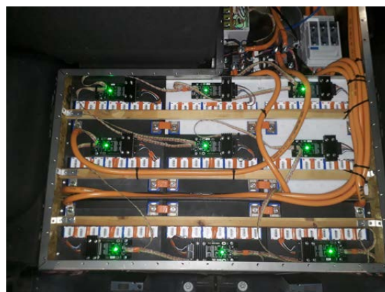
Das Batteriepack besteht aus zwölf Modulen mit je 8 Zellen
