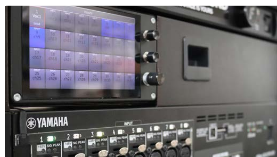
Eingebauter RIOT I Controller mit LED Boards auf der Stagebox Yamaha 3224-D
