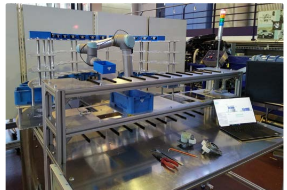
Kollaboratives Montagesystem im Betrieb
