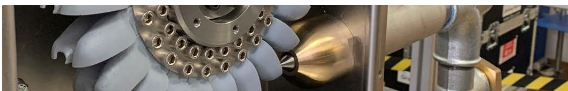
Lauftrad und Nadelventil der Anlage
