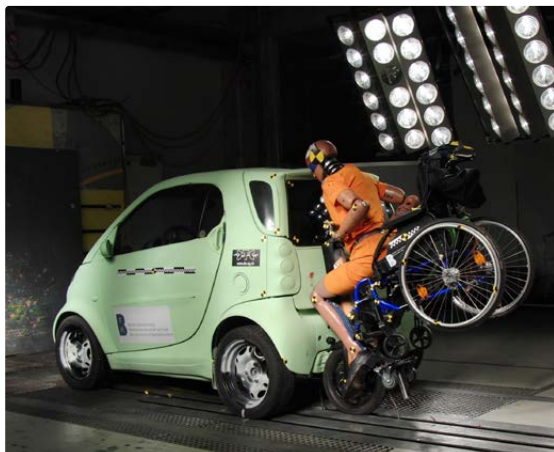
Crash test de collision du fauteuil roulant motorisé contre l'arrière d'un voiture
