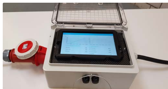
Die Messbox mit geöffneter Gehäusetür. Darin befindet sich der Touchscreen zur Steuerung und Datenanzeige
